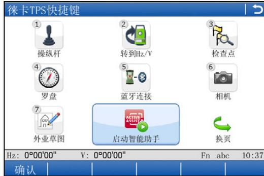
只能从徕卡 TPS 快捷键和徕卡 GPS 快捷键界面进入智能助手。请参考“2.1.4 Leica 快捷功能”。
