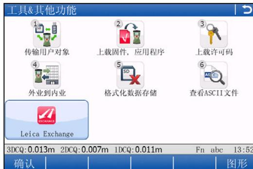
Leica Exchange 可从**工具 & 其他功能**菜单启动或直接按下热键（仅 CS15 外业控制手簿）。
